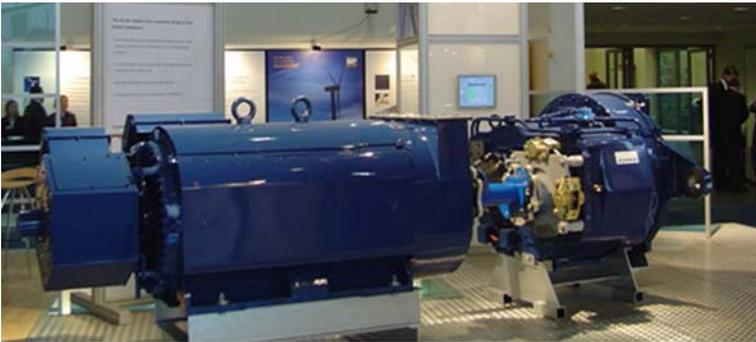
*Figura 18 - Gerador conectado a caixa de engrenagens (vista à direita)*
