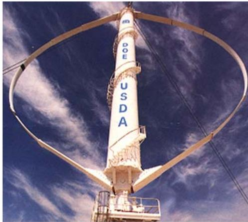
Figura 12 - Aerogerador experimental de eixo vertical (SANDIA, 2006)
