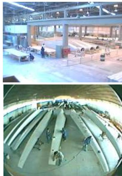
Fig. 9: Fabricação de pás de rotores eólicos
