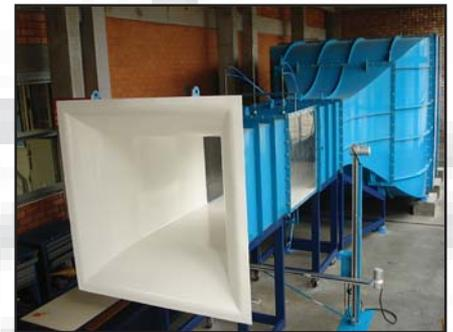
**Túnel de Vento para Testes de Turbinas Eólicas** - Realiza testes em turbinas eólicas de eixo vertical e horizontal para verificação do desempenho destes equipamentos, através do levantamento de suas curvas de potência. O túnel possui comprimento de 12 metros, a potência do motor é equivalente a 75kW, a rotação atinge 900 RPM e a seção de testes varia na faixa de 2,5m a 1,5m, atingindo uma velocidade de jato aberto em torno de 150km/h.
