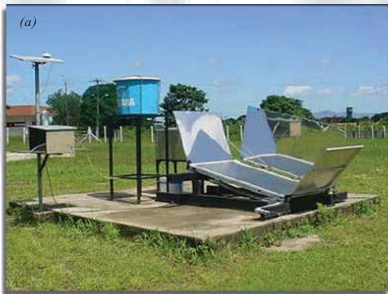
(a) Dessalinizador Solar Térmico com Recuperação de Calor
