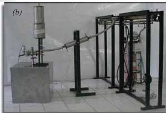
(b) Refrigerador Térmico por Ciclo de Absorção Movido a Gás Natural
