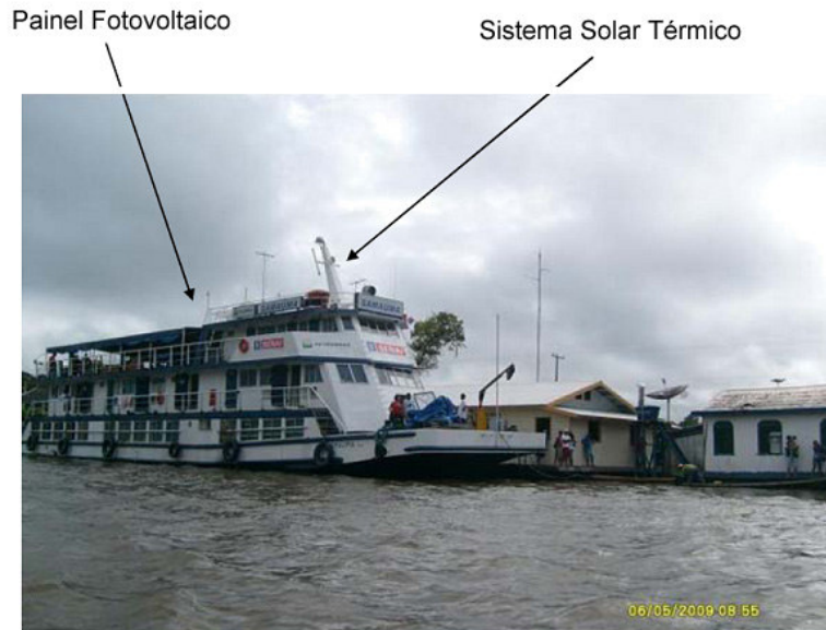
Figura 3 – Detalhe da embarcação Samaúma e localização dos painéis fotovoltaicos e sistema solar térmico.
