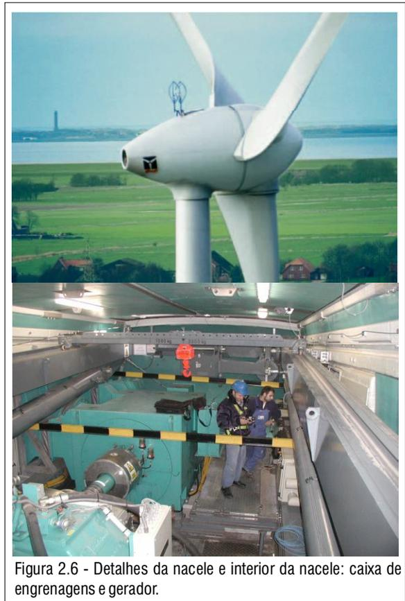
Figura 2.6 - Detalhes da nacela e interior da nacela: caixa de engrenagens e gerador.
