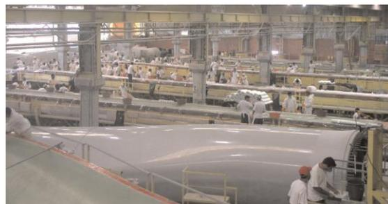
Fig. 2.2.3: Fabricação de pás em materiais compostos, para rotores de turbinas eólicas.
