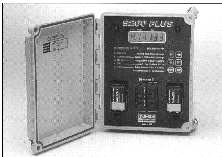
Figura 4.2 - Exemplo de um sistema de aquisição de dados de vento.
